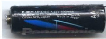
Celda o elemento de Ni-Cd (Níquel Cadmio)- de 1.25 V y 500 mAh
